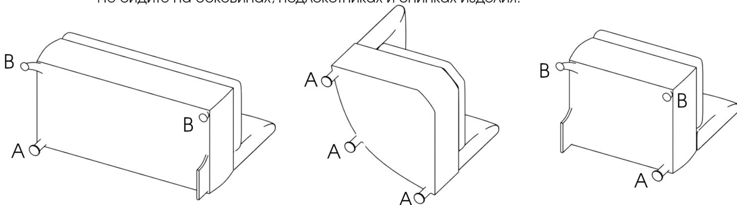
1. К нижней части диванных и кресельной части крепятся ножки, каждая на 3 самореза 30 мм.
