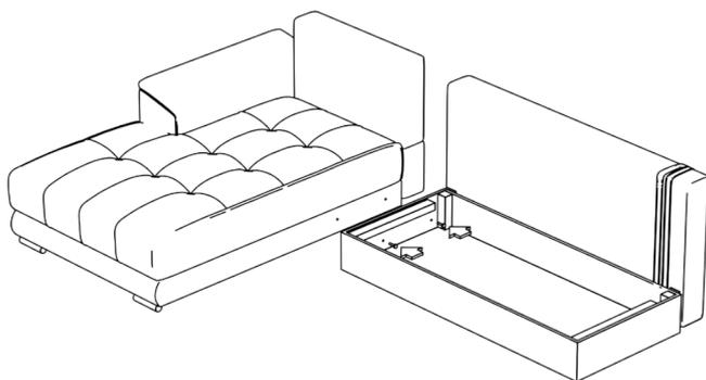
3. Прикрутить основную часть дивана к оттоманке 2 болтами М8 (90мм).
