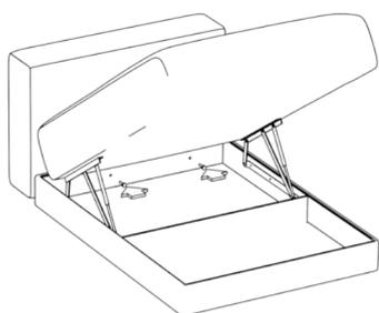
1. Прикрутить спинку к оттоманке двумя болтами М8 (90мм).
