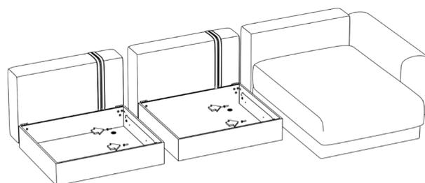
3. Прикрутить бельевой ящик блока сиденья при помощи 3-х шайб, 3-х болтов М8, между модулями на каждый болт установить по 3 нейлоновых шайбы и с обратной стороны зафиксировать гайкой М8.
